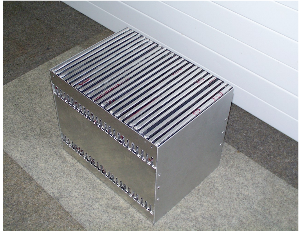
Aufbau Speichermodul: luftdurchströmter Stack aus Einzelplatten
