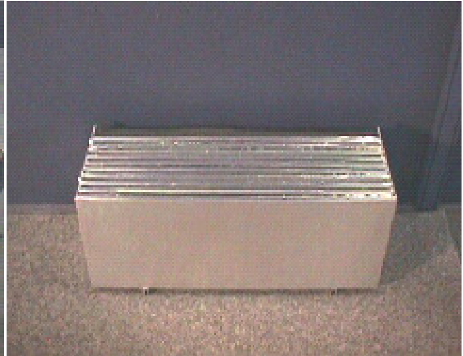
PCM-Modul mit 10 PCM-Platten
