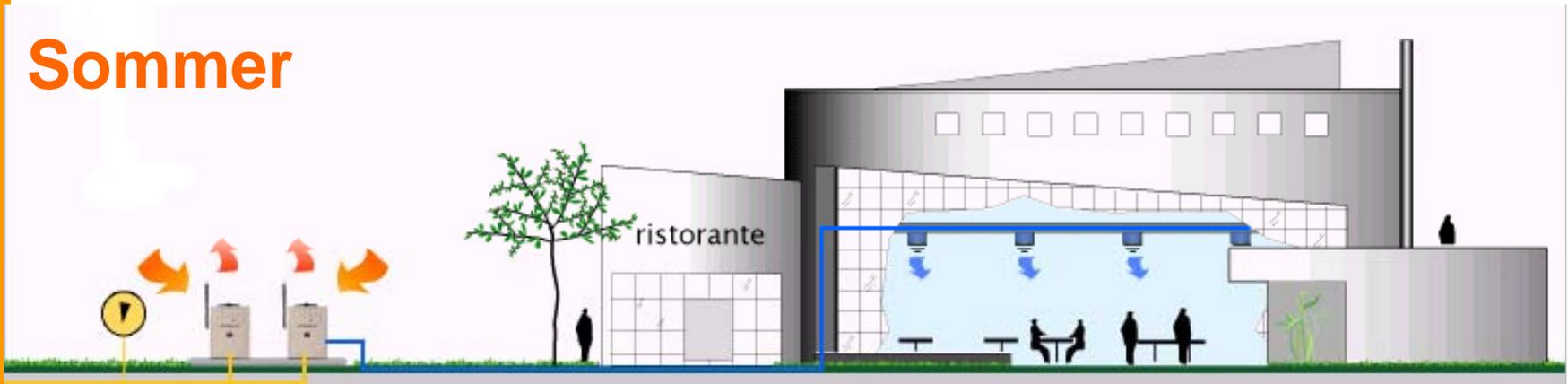
Im Sommer wird das Gebäude sanft gekühlt. Die Wärmepumpe GAHP-AR kann beide Anforderungen mit einem Gerät erfüllen.
