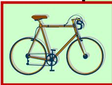
⇒ Pedal am Kettenrad und Übertragung durch Kette auf das Ritzel am Hinterrad
