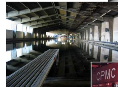
**1972** Eistank der 2. Generation startet Betrieb 30x6x1.2m
